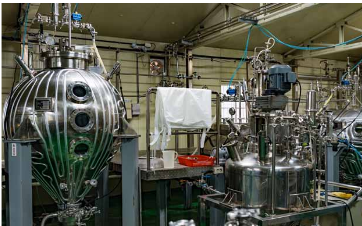
Bioreaktor wykorzystywany w hodowli tkankowej żeńszenia ( Panax ginseng C.A. Meyer) w Chungbuk National University
