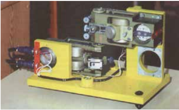
Rys. 3. Rotacyjny sejsmograf Droste'a i Teisseyre'a z 1976 roku
